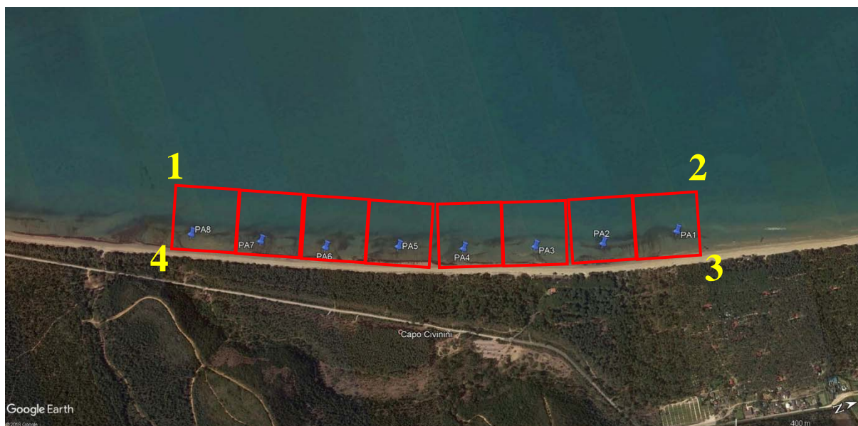
Figura 2 - Poligono di ipotetico dragaggio, maglie di caratterizzazione e stazioni di campionamento
